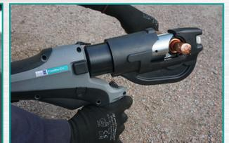
Dieses vielseitige, leistungsstarke Akku-hydraulische Presswerkzeug verarbeitet mit handelsüblichen C-Schalen-Presseneinsätzen Kabelschuhe und Verbinder bis 300 mm<sup>2</sup> nach DIN. In seiner Vielseitigkeit findet es Einsatz in den Bereichen EVU, Stadtwerke, der industriellen Kabelmontage oder der Windenergie.
